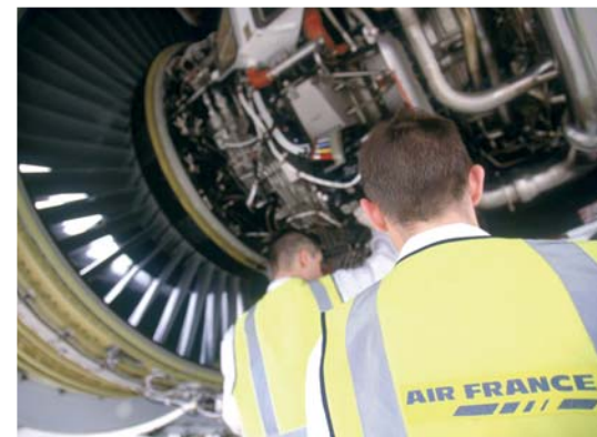
ce en piste d'un Boeing 777 d'Air France - intervention sur un moteur Photo : AF Ph Delafosse
