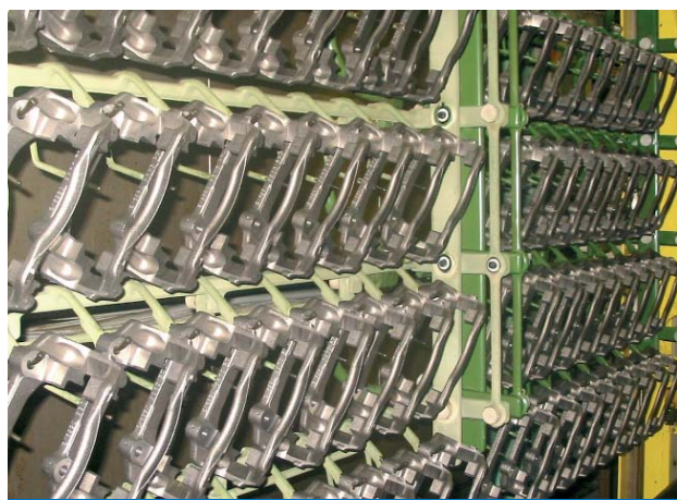
Outillage dynamique porteur de pièces pour limitation des entraînements en traitements de surface par zingage, pour pièces automobile
