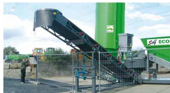
Le centre de tri de déchets du BTP de PICHETA (Pierrelaye) s'est doté d'un nouvel engin : une micro centrale à béton qui fonctionne en self-service, développée en Allemagne et exploitée pour la première fois en France par PICHETA. Cette bétonnière, entièrement automatisée et capable de produire 50 m<sup>3</sup> de béton et mortier par jour, a pour objectif de délivrer de petites quantités de béton, prêt à l'emploi (de 150 litres à 2-3 m<sup>3</sup>) aux artisans, PME PMI, et particuliers
