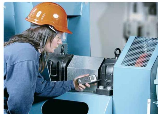
L'entreprise basée à Osny, dirigée par Eric de Soulait, vient de lancer sur le marché international un nouvel appareil : le *Bearing Checker*, dont la fabrication est assurée par la maison mère de SPM en Suède. Cette innovation se destine à déterminer rapidement et facilement l'état des
